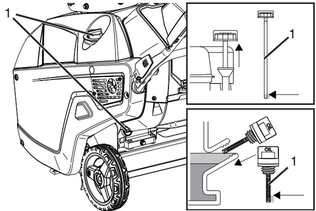
4. Führen Sie den Ölmesstab in den Einfüllstutzen ein und drehen Sie ihn so weit wie möglich im Uhrzeigersinn. Ziehen Sie den Ölmesstab wieder heraus, indem Sie ihn gegen den Uhrzeigersinn drehen.
