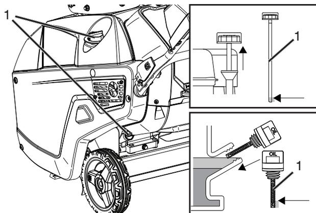
4. Inserire l'astina nel bocchettone di rifornimento ed avvitare a fondo in senso orario. Svitare in senso antiorario per estrarre l'astina.
