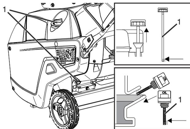
4. Introduzca la varilla en el cuello de llenado y gírela hacia la derecha hasta que quede totalmente instalada. A continuación extraiga la varilla de nivel de aceite girándola hacia la izquierda.
