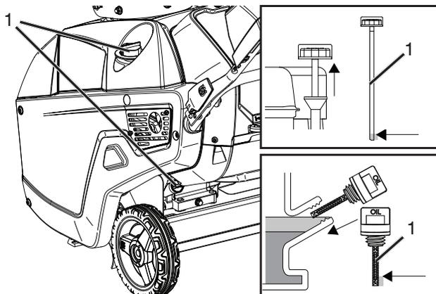
4. Plaats de peilstok terug in de vulopening en draai hem rechtsonder tot hij volledig op zijn plaats zit. Verwijder vervolgens de peilstok door deze linksom te draaien.
