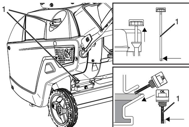
4. Inserire l'astina nel bocchettone di rifornimento ed avvitarla a fondo in senso orario. Svitare in senso antiorario per estrarre l'astina.
