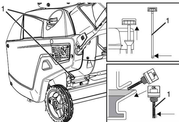
4. Plongez la jauge dans la goulotte de remplissage et tournez-la dans le sens horaire jusqu'à ce qu'elle soit bien en place. Ressortez la jauge en tournant dans le sens anti-horaire.
