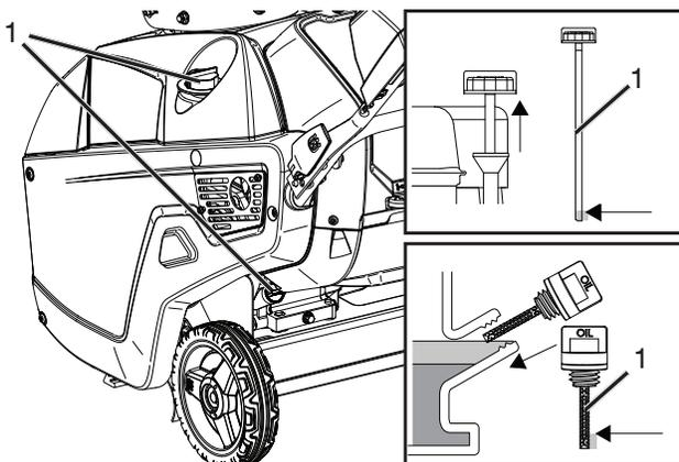
4. Plaats de peilstok terug in de vladdop en draai hem rechtsonder totdat hij volledig op zijn plaats zit. Verwijder vervolgens de peilstok door deze linksom te draaien.
