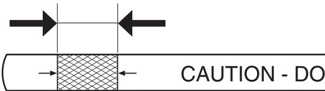
**(FR)** Le niveau d'huile doit se situer entre les deux marques indiquées sur la jauge d'huile. Si nécessaire, ajoutez de l'huile jusqu'en haut de la section hachurée sur la jauge. Pour connaître la capacité approximative et le type d'huile, reportez-vous à la section « CARACTÉRISTIQUES DU PRODUIT » du présent manuel. Ne remplissez pas excessivement.
