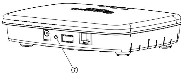
Das smart Gateway wird in den Werkzustand zurückgesetzt. Die Reset-Funktion kann zur Anwendung kommen, wenn Sie z. B. Ihr Gateway in einem neuen WLAN-Netzwerk einbinden wollen.
