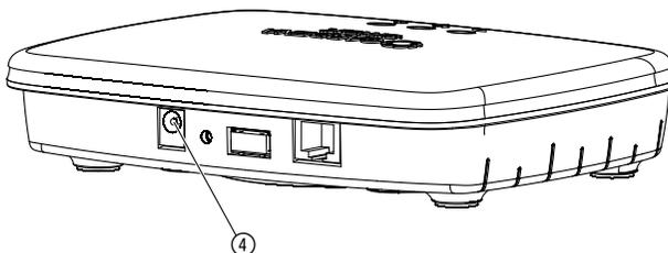
1. Stecken Sie das Steckernetzteil in eine Netzsteckdose.
