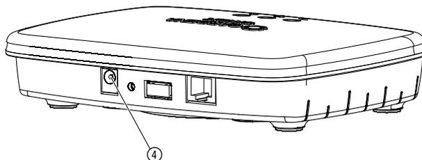
1. Utaknite jedinicu za napajanje u strujnu utičnicu.
