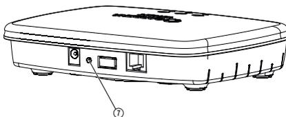
Das smart Gateway wird in den Werkzustand zurückgesetzt (nicht aus einem bestehenden GARDENA smart system Account gelöscht).
