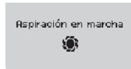
**El proceso de aspiración puede durar hasta 6 minutos. Si transcurrido este tiempo ya no se bombea más agua, la estación de bombeo para casa y jardín se desconecta y la pantalla indica "ERROR 2" (véase 7. SOLUCIÓN DE AVERÍAS).**
