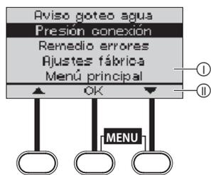
En función de la indicación se puede consultar información actual sobre el estado de funcionamiento y realizar diversos ajustes.
