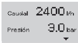
Cierre los dispositivos de cierre en la línea de impulsión en cuanto la bomba empiece a transportar agua de forma constante.
