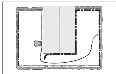
Continúe hasta que solo quede una sección muy corta del cable, que será la diferencia entre una luz verde fija y una luz azul intermitente. Después, siga las instrucciones del paso 5 a continuación.
