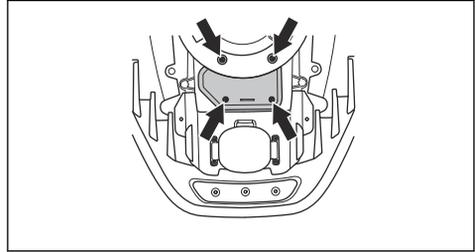
6. Quite el tornillo del soporte de la batería y retire el soporte.
