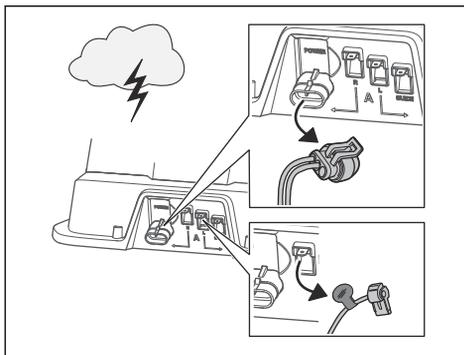
Para reducir el riesgo de daños en los componentes eléctricos del producto y en la estación de carga, recomendamos desconectar todas las conexiones de la estación de carga (suministro eléctrico, cable delimitador y cable guía) si existe riesgo de tormenta eléctrica.
