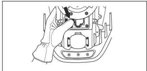
9. Fije el soporte de la batería en su posición con un tornillo.
