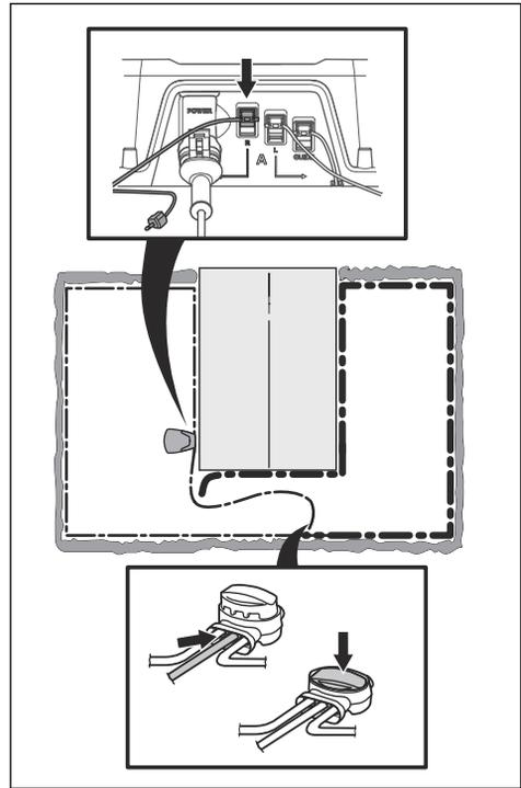
Si la luz indicadora ahora es verde, la rotura está en algún lugar del cable entre el extremo desconectado y el punto donde se conecta el cable nuevo (la siguiente línea negra y gruesa). En ese caso, acerque la conexión del cable nuevo a la punta desconectada (más o menos, en la mitad de la sección del cable que podría estar dañada) y vuelva a comprobar si la luz indicadora está en verde.
