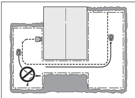
La prueba no se superará si el producto no puede seguir el cable guía hasta el punto de conexión con el cable delimitador. Es probable que la instalación no se haya llevado a cabo de acuerdo con las instrucciones de *Instalar el cable guía en la página 22*.
