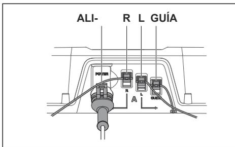
3. Intercambie las conexiones del cable guía y el cable delimitador en la estación de carga. Para empezar, intercambie las conexiones L y GUIDE.
