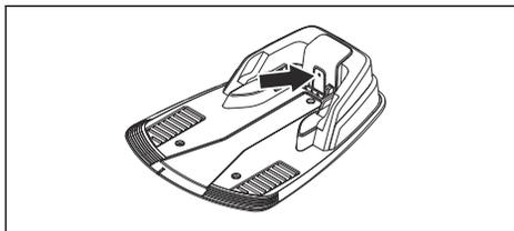
2. Compruebe que las conexiones del cable delimitador a la estación de carga están conectadas correctamente y no están dañadas. Compruebe que la luz indicadora de la estación de carga sigue parpadeando en azul.
