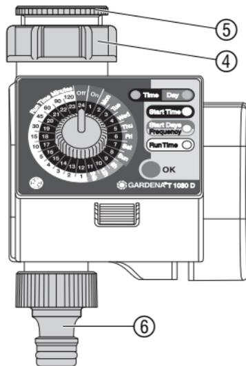
Le programmeur est équipé d'un écrou ④ fileté 33,3 mm (G1"). L'adaptateur ⑤ fourni sert à brancher le programmeur sur des robinets à filetage 26,5 mm (G $\frac{3}{4}$ ").
