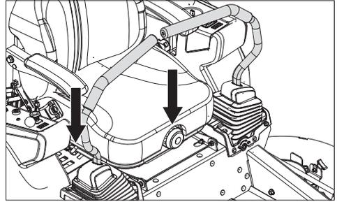
El asiento se puede ajustar longitudinalmente con la palanca situada en el lado derecho del asiento. Cuando se realizan ajustes, la palanca se mueve hacia arriba. Se pueden hacer ajustes en la suspensión del asiento girando la perilla central.
