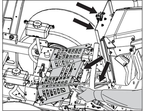
3. Levante la lengüeta de la protección del ventilador.
