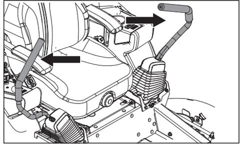
El freno de estacionamiento está integrado con las palancas de control de la dirección. Mueva las palancas hacia afuera de la posición neutra para acoplar el freno de estacionamiento.
