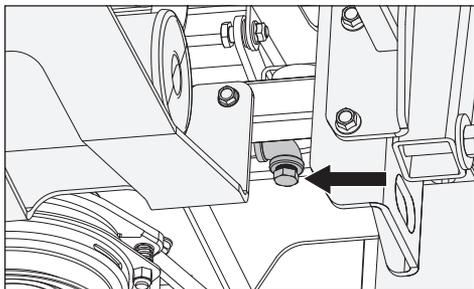
5. Permita que el aceite se drene completamente del motor.
