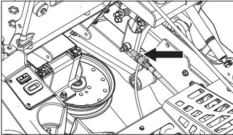
4. Retire y guarde el pasador del acoplador delantero.
