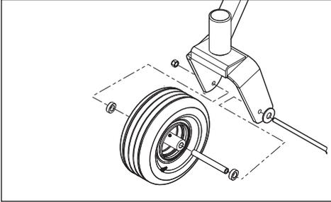
*NOTA: El neumático debe girar libremente pero los espaciadores del eje no. Si las ruedas no giran libremente, lleve la unidad al distribuidor para el servicio.*
