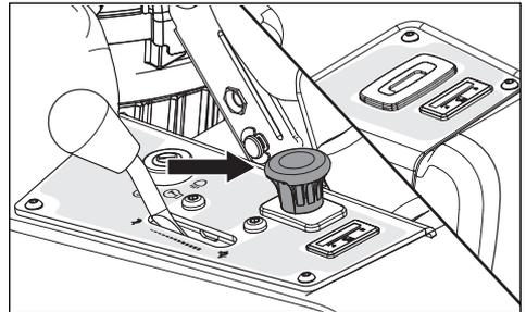
Para acoplar el equipo de corte, tire de la perilla hacia afuera; las cuchillas de corte se desacoplan cuando la perilla se presiona hacia abajo.
