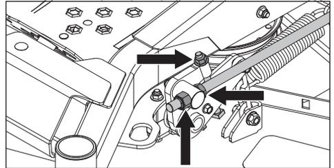
3. Gire ambas cuchillas exteriores para alinearlas con el equipo desde la parte delantera a la trasera. Cambie de posición los cáncamos de montaje hacia arriba o hacia abajo hasta que las puntas de las puntas traseras de la cuchilla estén de 3.175 mm a 9.525 mm más alto en la parte trasera que las puntas de la cuchilla delanteras.
