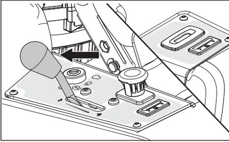
El acelerador regula el régimen del motor y, por lo tanto, la velocidad de rotación de las cuchillas, asumiendo que el interruptor de la cuchilla se ha accionado, consulte la sección Conexión del equipo de corte.
