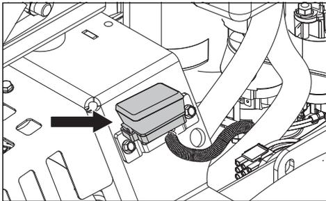
Los fusibles están situados en el lado derecho de la máquina y se accede a ellos inclinando el asiento hacia adelante. Los fusibles son de tipo plano como los que se usan en los automóviles. El de 20 A es el fusible principal. El de 7,5 A es para el acoplamiento del equipo de corte. El de 10 A es para los accesorios.
