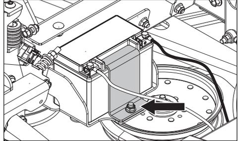
3. Con dos llaves, desconecte el cable de la batería NEGRO y después el cable de la batería ROJO.
