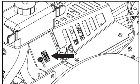
La válvula de corte de combustible está ubicada en la parte trasera derecha del asiento. La válvula tiene tres posiciones: depósito derecho y depósito izquierdo y cerrada.
