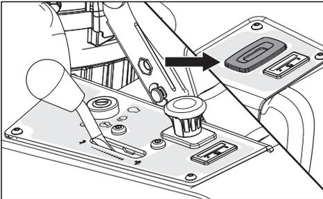
El medidor de servicio se encuentra en el panel de control izquierdo y muestra el tiempo total de funcionamiento con la cuchilla activada.
