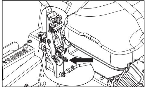
3. Para cambiar el funcionamiento del freno de estacionamiento, apriete el perno del pivote hasta que logre la sensación de frenado deseada.
