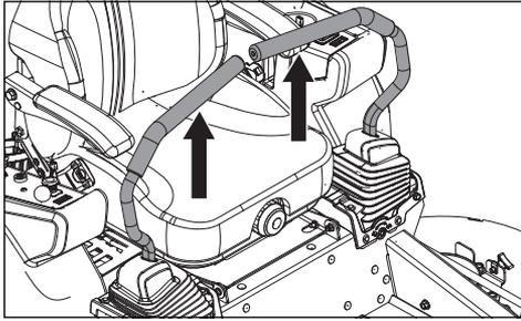
La velocidad y la dirección de la máquina son de tipo variable continua con los dos controles de la dirección. Los controles de la dirección se pueden mover hacia adelante o hacia atrás sobre una posición neutra. Además, hay una posición neutra que se bloquea si los controles de la dirección se mueven hacia afuera.
