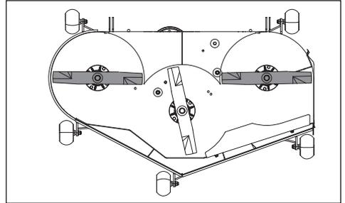
2. Mida desde la superficie del suelo hasta la parte inferior de la punta de la cuchilla en el lado de descarga del equipo de corte. Anote esta medida. Vaya al lado opuesto y compruebe que la medida sea la misma. Si se requiere un ajuste, afloje la tuerca de bloqueo y desplace el perno hacia arriba hasta que ambas mediciones laterales sean idénticas. Anote la medida.
