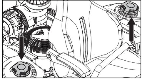
Lea las instrucciones de seguridad antes de cargar combustible. La capacidad para cada tanque es de 22.7 litros. Revise con regularidad la junta del tapón de la gasolina para ver si hay daños y mantenga la tapa debidamente apretada.
