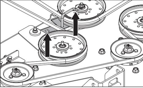
4. Con una barra de palanca de 1/2" y utilizando la abertura cuadrada del brazo guía, gire el brazo contra el sentido de las agujas del reloj para liberar la tensión de la correa.
