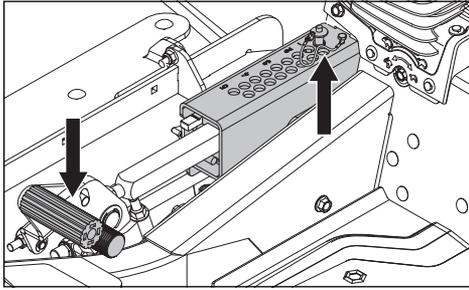
Los pedales de altura de corte sueltan la elevación del equipo para que se pueda ajustar la altura del equipo deseada. Aplique presión al pedal de elevación y gire el pie para también aplicar presión al pedal de liberación, desbloqueando la elevación del equipo.
