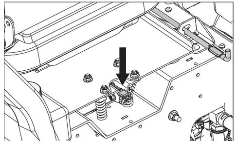
El asiento se puede girar hacia delante para acceder a la batería del cortacésped y al equipo hidráulico. Presione hacia abajo la palanca del seguro para liberar el asiento. Levante el asiento hasta que la varilla se acople.
