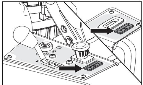
Los indicadores de combustible de los depósitos de combustible se encuentran en los paneles de control izquierdo y derecho.
