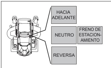
El giro cero se puede lograr moviendo un control hacia atrás (detrás de la posición neutra) y desplazando con cuidado el otro control de la dirección hacia adelante desde su posición neutra. El sentido de rotación durante el giro cero se determina según el control de la dirección que se mueva hacia atrás por detrás de la posición neutra. Si el control de la dirección izquierdo se mueve hacia atrás, la máquina gira a la izquierda. Tenga mucho cuidado al realizar esta maniobra.
