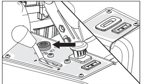
El interruptor de encendido se utiliza para arrancar y detener el motor. En los modelos equipados con faros, gire la llave en el sentido de las agujas del reloj, hasta la posición ACCESSORY (Accesorio) para usar los faros.
