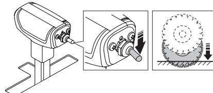
**REMARQUE !** Lors de l'abaissement de la lame dans une coupure partielle, alignez exactement la lame avec la coupure pour éviter d'endommager la lame.
