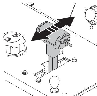
**¡ATENCIÓN!** No coloque la transmisión en posición neutra mientras la máquina está aparcada en una pendiente pronunciada. El operario perderá el control y podrían producirse daños o lesiones.
