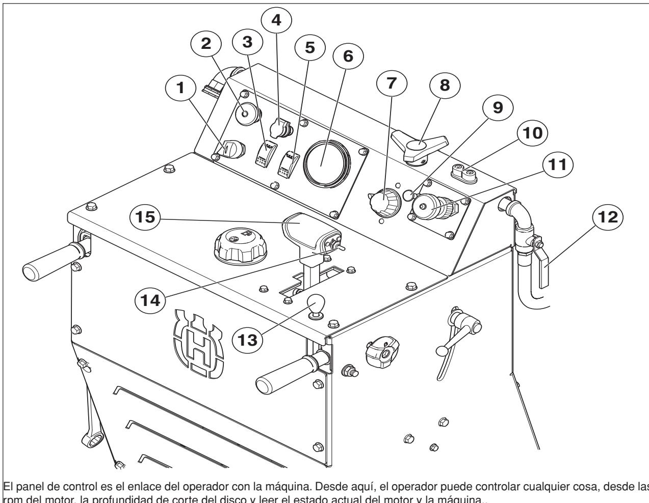
El panel de control es el enlace del operador con la máquina. Desde aquí, el operador puede controlar cualquier cosa, desde las rpm del motor, la profundidad de corte del disco y leer el estado actual del motor y la máquina..
