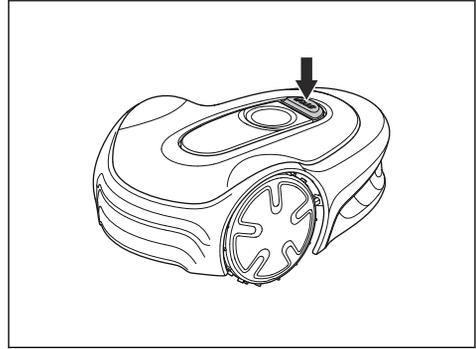
**Hinweis:** Wenn Sie die **STOP**-Taste drücken, befindet sich das Gerät im Leerlauf. Das Gerät hält an, und der Schneidmotor kommt zum Stillstand.
