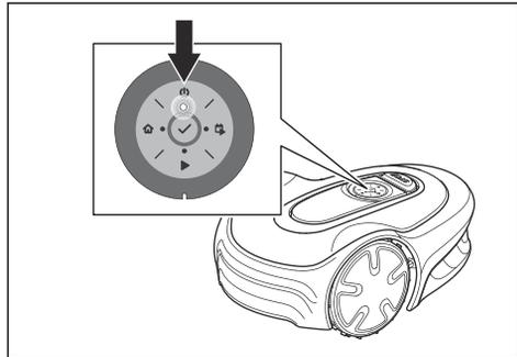
3. Stellen Sie sicher, dass die Anzeigelampe an der Tastatur nicht leuchtet.
