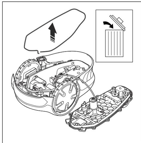
14. Setzen Sie einen neuen Dichtungsstreifen in das obere Chassis ein. Beginnen Sie, indem Sie ein Ende des Dichtungsstreifens auf die Markierung des Chassis legen.
