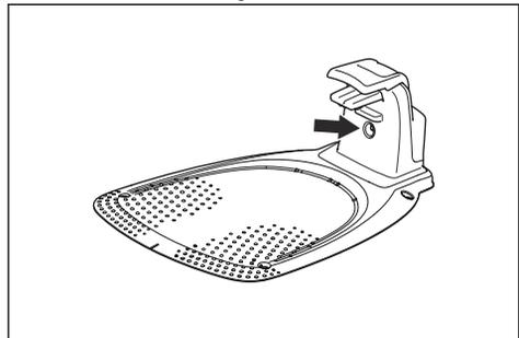
2. Wenn die LED-Anzeigeleuchte nicht grün leuchtet, führen Sie eine Überprüfung der Installation durch. Siehe *Anzeigelampe an der Ladestation auf Seite 39* und *Installieren der Ladestation auf Seite 18*.
