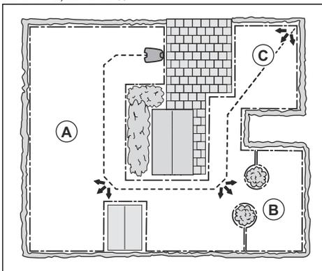
Die Funktion *CorridorCut* eignet sich für das Mähen schmalen Passagen mit einer Breite von 60 cm – 1.5 m / 2 ft. – 4.9 ft. Das Gerät bewegt sich in einem Muster, um die Gesamtbreite der Passage abzudecken. Das Gerät startet den *CorridorCut* in der festgelegten Distanz von der Ladestation. Wenn das Gerät das Ende der schmalen Passage erreicht, fährt es auf normale Weise mit dem Mähen fort.
