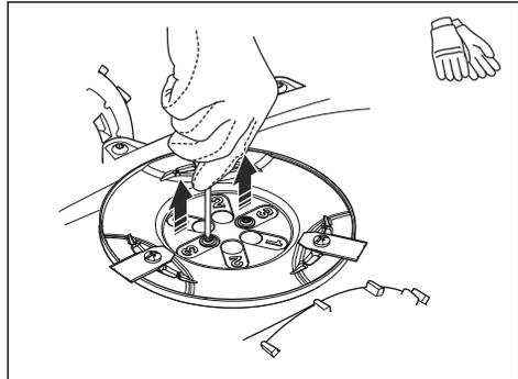
8. Setzen Sie den Klingenteller auf die Welle. Wählen Sie eine Schnitthöhe aus, und richten Sie die 2 Löcher auf dem Klingenteller an den 2 Löchern in der Welle aus.
