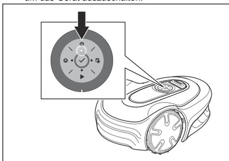
3. Stellen Sie sicher, dass das Gerät deaktiviert ist. Die Anzeigelampe an der **ON/OFF**-Taste leuchtet nicht, wenn das Gerät deaktiviert ist. Siehe *LED-Statusanzeige auf der Tastatur auf Seite 6*.
