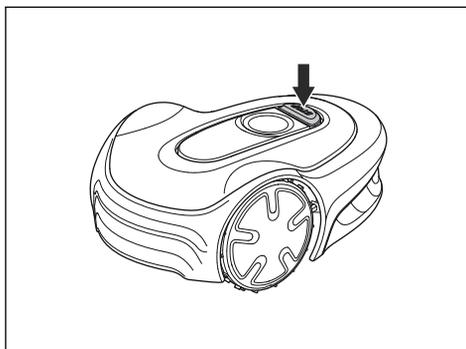
2. Drücken Sie die **ON/OFF**-Taste 3 Sekunden lang, um das Gerät auszuschalten.
