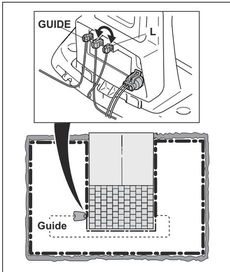
Zur Behebung des Fehlers benötigen Sie Begrenzungskabel, Anschlussklemme(n) und Verbinderr:
