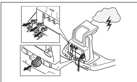
Pour réduire le risque d'endommagement des composants électriques du produit et de sa station de charge, nous recommandons de défaire tous les branchements de la station de charge (alimentation électrique, câble périphérique et câble guide) en cas de risque d'orage.
