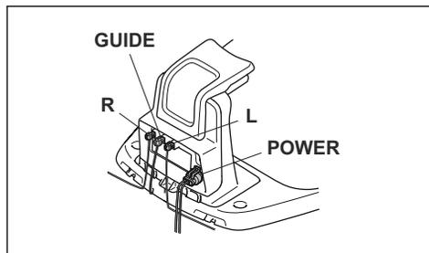
3. Permutez les raccordements entre le câble guide et le câble périphérique de la station de charge. Commencez par échanger les connexions L et GUIDE.
