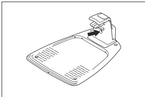
2. Vérifiez si les raccordements du câble périphérique à la station de charge sont correctement effectués et non endommagés. Vérifiez si le voyant de la station de charge clignote toujours en bleu.
