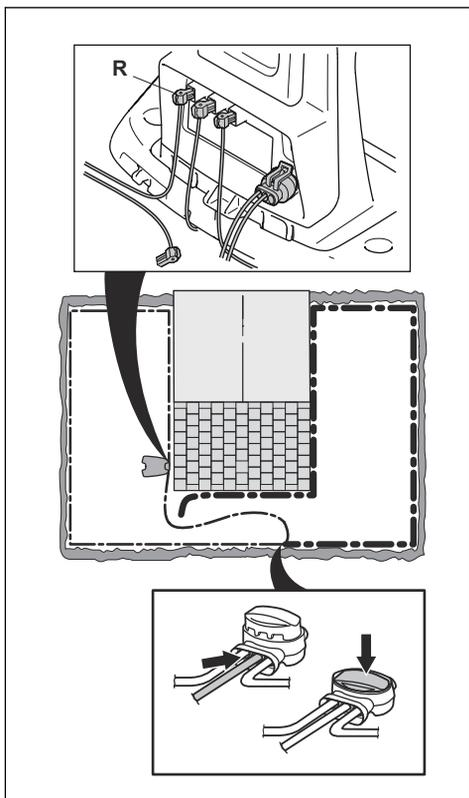
Si le voyant est maintenant jaune clignotant, cela signifie que la coupure se trouve quelque part entre l'extrémité débranchée et l'endroit où le nouveau câble est branché (ligne noire épaisse sur l'illustration). Dans ce cas, déplacez la connexion destinée au nouveau câble plus près de l'extrémité débranchée (en gros, au milieu de la partie du câble suspectée) puis vérifiez de nouveau que le voyant est vert.
