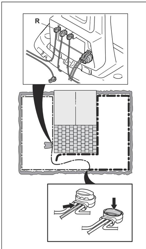
Εάν η ενδεικτική λυχνία αναβοσβήνει πλέον κίτρινη, η διακοπή βρίσκεται σε κάποιο σημείο στο καλώδιο μεταξύ του αποσυνδεδεμένου άκρου και του σημείου σύνδεσης του νέου καλωδίου (η παχιά μαύρη γραμμή παρακάτω). Εάν ισχύει αυτό, μετακινήστε τη σύνδεση για το νέο καλώδιο πιο κοντά στο αποσυνδεδεμένο άκρο (περίπου στο μέσον του πιθανού τμήματος καλωδίου) και ελέγξτε ξανά αν ανάβει με πράσινο χρώμα η ενδεικτική λυχνία.
