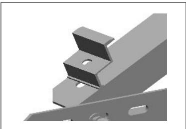
1. Instale los soportes de los bordes superiores en ambos lados y, luego, instale los soportes de los bordes inferiores en ambos lados
