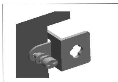
Insérez la pièce G (x 4) dans les trous sur les supports (x 4), puis alignez les boulons de la pièce G (x 4) à l'horizontale et serrez-les.
