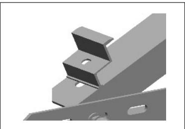
1. Installez le support de rebord supérieur des deux côtés, puis installez le support de bord inférieur des deux côtés
