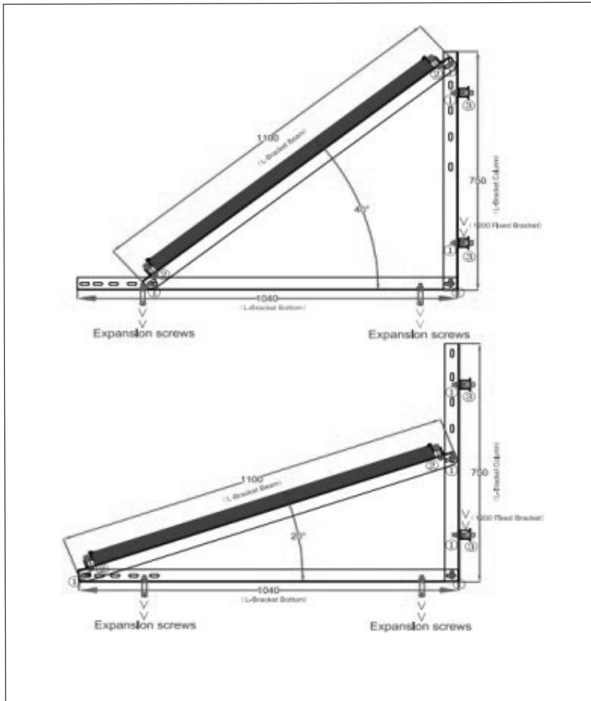
1. > Tornillo de cabeza M8X25 + una tuerca de brida + una arandela de bloqueo
