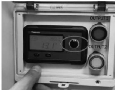
NOTA Los dos botones de salida junto al monitor son para encender y apagar las salidas de la estación de carga.
