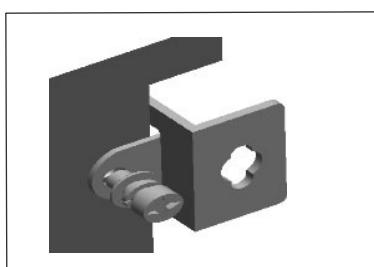
Inserte la Pieza G (x4) en los orificios de los soportes (x4), luego alinee los pernos de la Pieza G (x4) horizontalmente y apriete.
