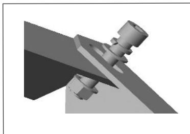
Conecte la Pieza (B) a la Pieza (D) y apriete la Pieza (F) con la llave Allen y la llave de tubo. Repita el procedimiento en el otro lado. A continuación, coloque la Pieza (C) en la Pieza (B) y apriete para juntarlas con la Pieza (F) con la llave Allen y la llave de tubo.
