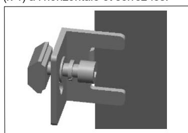
Utilisez la pièce A (x 2) (supports) et faites-la glisser horizontalement dans les deux ensembles d'écrous de fer en U au haut et au bas.
