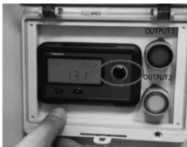
**REMARQUE** Les deux boutons de sortie à côté du moniteur servent à activer et à désactiver les sorties de la station de charge.
