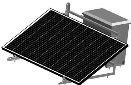
Una vez que el panel esté bien sujeto, enchufe el panel solar a través de los conectores MC-4 a los conectores MC-4 que salen de la carcasa (macho > hembra, hembra > macho).
