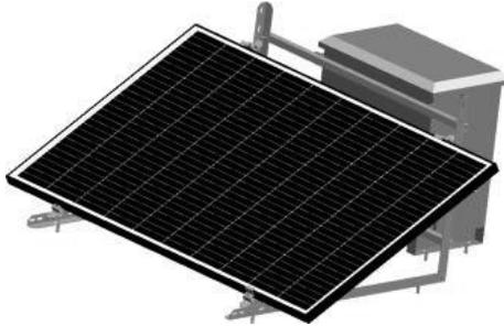
Als het paneel eenmaal vast zit, sluit u het zonnepaneel aan met de bevestigde MC-4- connectoren aan de MC-4-connectors die uit de behuizing komen (mannelijk > vrouwelijk, vrouwelijk > mannelijk).
