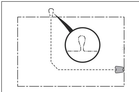
**Περιεχόμενα** Δημιουργήστε ένα προσχέδιο της περιοχής εργασίας προτού τοποθετήσετε το καλώδιο οριοθέτησης και το καλώδιο οδήγησης.
