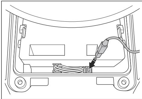
3. Μεταβείτε στη διεύθυνση [www.gardena.com](http://www.gardena.com), πραγματοποιήστε αναζήτηση και κατεβάστε το εργαλείο ενημέρωσης υλικολογισμικού και ακολουθήστε τις δογμές.
