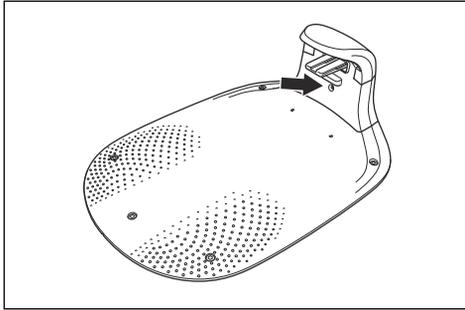
2. Wenn die LED Anzeigelampe nicht grün leuchtet, führe eine Überprüfung der Installation durch. Siehe *Anzeigelampe an der Ladestation auf Seite 42* und *Installieren der Ladestation auf Seite 19*.
