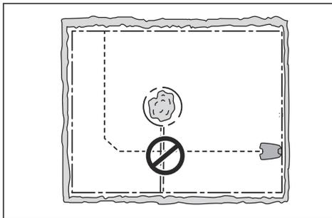
Um eine Insel zu erstellen, isolieren Sie Bereiche im Arbeitsbereich mit dem Begrenzungskabel. Wir empfehlen, alle festen Objekte im Arbeitsbereich zu isolieren.
