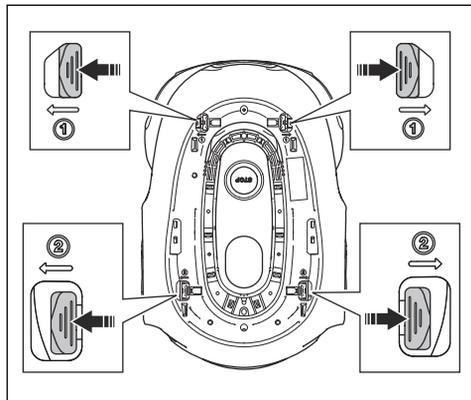
3. Drücke auf die Clips, die sich an der Vorderseite des Gehäuses des Geräts befinden.
