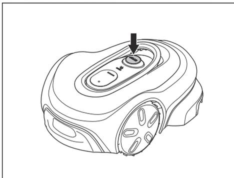
**Hinweis:** Wenn Sie die **STOP**-Taste drücken, befindet sich das Gerät im Leerlauf. Das Gerät hält an, und der Schneidmotor kommt zum Stillstand.
