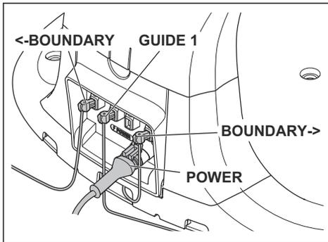
3. Verbinden Sie die Anschlüsse von Leitkabel und Begrenzungskabel mit der Ladestation.
