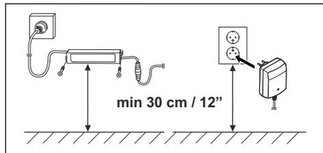
9. Schließe das Netzteil an eine Steckdose mit 100–240 V an.
