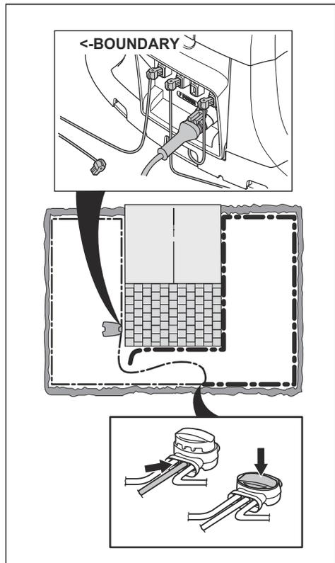
Blinkt die Anzeigelampe jetzt gelb, befindet sich der Bruch an einer Stelle zwischen dem ausgesteckten Ende und der Stelle, an der das neue Kabel angeschlossen wurde (dicke schwarze Linie unten). Verschieben Sie in diesem Fall das neue Kabel näher in Richtung ausgestecktes Ende (ungefähr in der Mitte des Bereichs, in dem der Bruch vermutet wird), und prüfen Sie erneut, ob die Anzeigelampe grün leuchtet.
