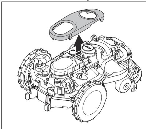
4. Entferne die USB-Abdeckung mit einem Schlitzschraubendreher.
