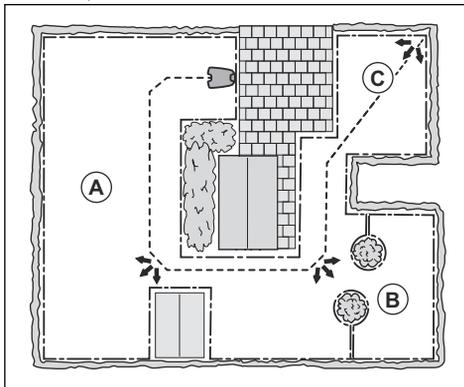
Die Funktion *CorridorCut* eignet sich für das Mähen schmaler Passagen mit einer Breite von 60 cm – 1.5 m/ 2 ft. – 4.9 ft. Das Gerät bewegt sich in einem Muster, um die Gesamtbreite der Passage abzudecken. Das Gerät startet den *CorridorCut* in der festgelegten Distanz von der Ladestation. Wenn das Gerät das Ende der schmalen Passage erreicht, fährt es auf normale Weise mit dem Mähen fort.
