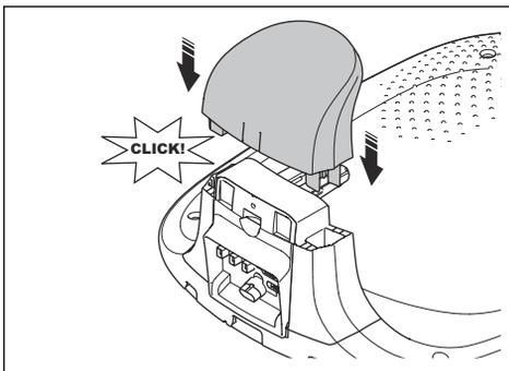
5. Wenn das Lademodul entfernt werden muss, drücke von unten mit dem Inbusschlüssel gegen die Clips. Entferne das Lademodul.
