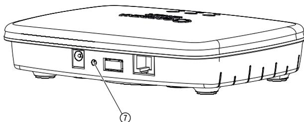
Naprava smart Gateway se ponastavi nazaj na tovarniške nastavitve. Funkcija ponastavitve se lahko uporabi, če npr. želite svojo napravo gateway povezati z novim WLAN-omrežjem.
