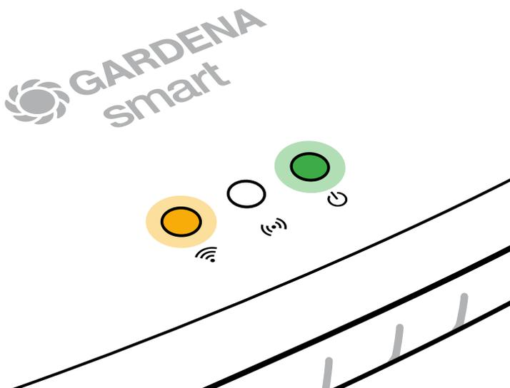
Konfiguracijsko omrežje ostane aktivno 15 minut. Po poteku 15 minut (ali če je bil gateway prej konfiguriran za drug WLAN, ki zdaj ni več na voljo), je mogoče konfiguracijsko omrežje znova aktivirati s kratkim pritiskom na tipko za ponastavitev ⑦.
