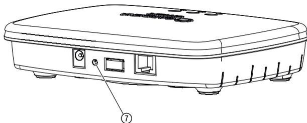
O smart Gateway é reposto para as definições de fábrica. Poderá ter de utilizar a função de reposição se, por exemplo, pretender associar o gateway a uma rede Wi-Fi nova.
