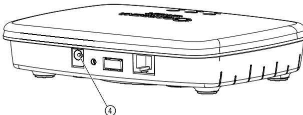
1. Ligue a unidade de fonte de alimentação a uma tomada de parede.
