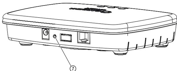
Saranno ripristinate le impostazioni di fabbrica dello smart Gateway. La funzione di reset può trovare applicazione ad es. quando si vuole collegare il gateway in una nuova rete WLAN.
