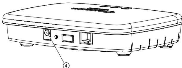
1. Infilare l'alimentatore in una presa di alimentazione.
