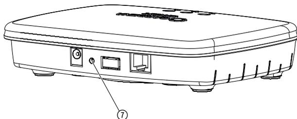
El smart Gateway recupera la configuración de fábrica. La función de reset puede utilizarse, p.ej., si desea asociar su gateway a una nueva red Wi-Fi.
