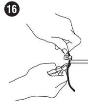
Si es necesario, corte los cables de forma que solo sobresalgan entre 1 y 2 cm.
