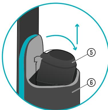
2. Ziehen Sie den Batteriefach-Deckel ⑤ nach außen bis Sie ein Klicken hören und ziehen Sie dann den Batteriefach-Deckel ⑤ nach oben ab.
