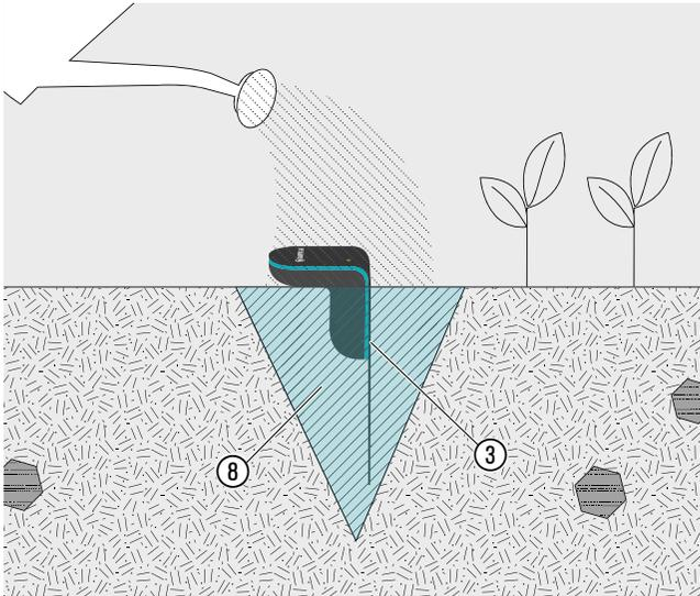
6. Stecken Sie den Sensor bis zur Unterkante des waagrechten Teils des Sensorkopfes in den Boden ⑧ ein. (Der Sensor muss mindestens bis zur **min**-Markierung in die Erde gedrückt werden).
