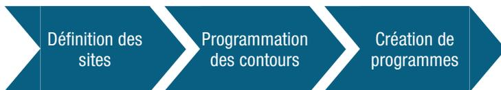
Un contour est composé d'un minimum de deux coins et d'un maximum de 360 coins. Les contours doivent être programmés dans le sens des aiguilles d'une montre. Commencez toujours par le premier point de contour à l'extrême gauche de la zone d'arrosage requise. Les points de contour peuvent être modifiés par la suite.
